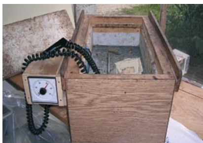
Couveuse de transport avec une prise sur allume-cigare et ampoules de 12 V
